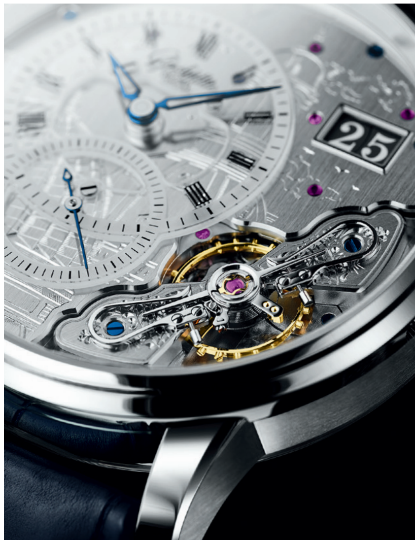
自社製キャリバー 91-03は、通常のムーブメント構造を反転させ、グラスヒュッテの時計製造の特徴である4分の3プレートを表側に配置。ダブルスワンネック緩急針の受けにもパロク調の装飾仕上げを見ることができる。
